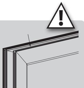
Schrauben Sie die Montageclips auf das Fensterprofil. Die Clips verfügen über diverse Schraublöcher, sodass nicht, in die thermische Trennung des Fensterprofils geschraubt wird. Schrauben gehören nicht zur Lieferung; verwenden Sie Abhängig von der Art des Fensterprofils (Holz, Alu oder PVC) die geeigneten Schrauben. Verwenden Sie mindestens 2, vorzugsweise 3 und maximal 4 Schrauben.
